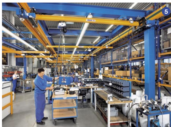
Sistemul ABUS EHB cu două căi de rulare, utilizat în transportul și așezarea precisă a pieselor compacte
