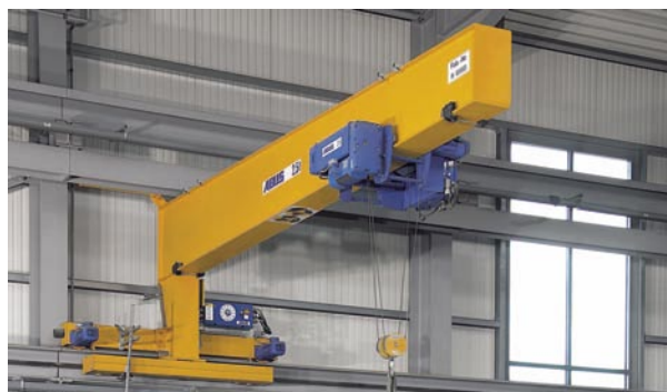
Pod rulant monogrindă în consolă, construcție compactă: echipat cu electropalan ABUS E
