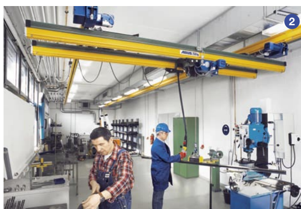
Sistemul ABUS ZHB cu două grinzi portante, utilizat într-un atelier de reparații
