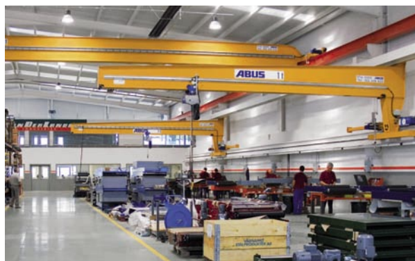
Pod rulant monogriindă în consolă ABUS EKL, utilizat la transportul diverselor materiale
